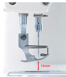
Máquina con prensatela de teflón para mejor deslizamiento del material.
